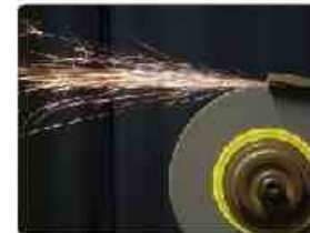
Fig. (17): Pourquoi la limaille métallique éjectée se déplace en ligne droite avec des vitesses tangentielles en utilisant une pierre à aiguiser électrique ?
